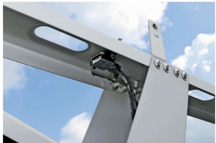
Für SwingStop und CurveControl messen Beschleunigungssensoren an den Gestängendeenden die Geschwindigkeit.
