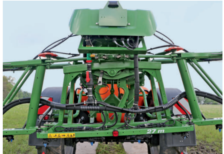
Bei DistanceControl kann das Gestänge frei pendeln. Dämpfer und Federn sorgen dafür, dass das Gestänge nicht aufschwingt.
