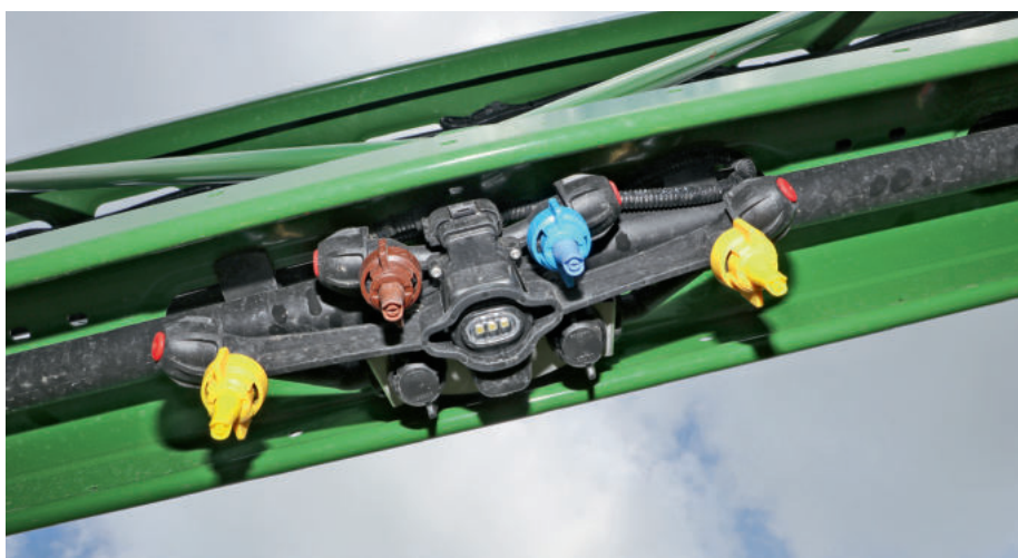
Die AmaSelect-Einzeldüsen-schaltung mit dem Verlagerungssatz für 25 cm Düsenabstand bei den gelben Düsen und verfügt über eine LED-Einzeldüsenbeleuchtung.
