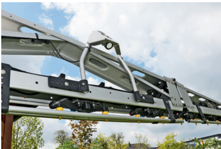
Ultraschallsensoren überwachen den Abstand des Gestänges zu den Pflanzen; die Hydraulik regelt dann nach.
