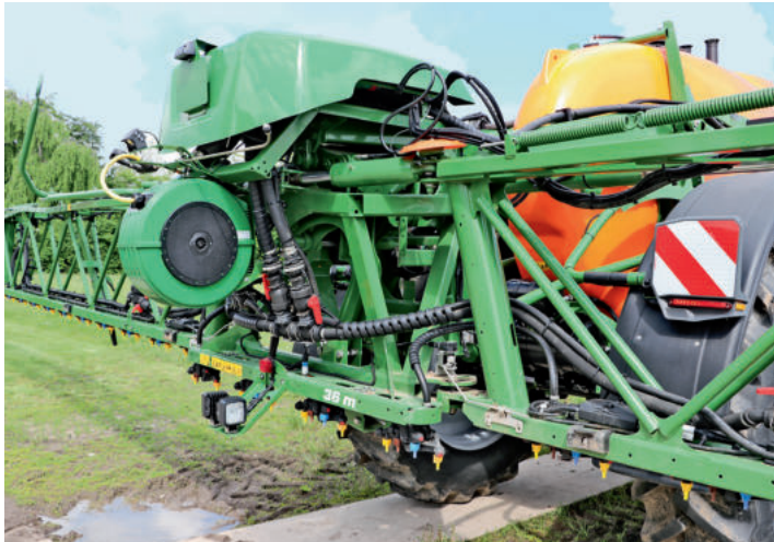
Bei der aktiven Gestängeführung ContourControl wird das Gestänge hydraulisch im richtigen Abstand zur Fläche geführt.
