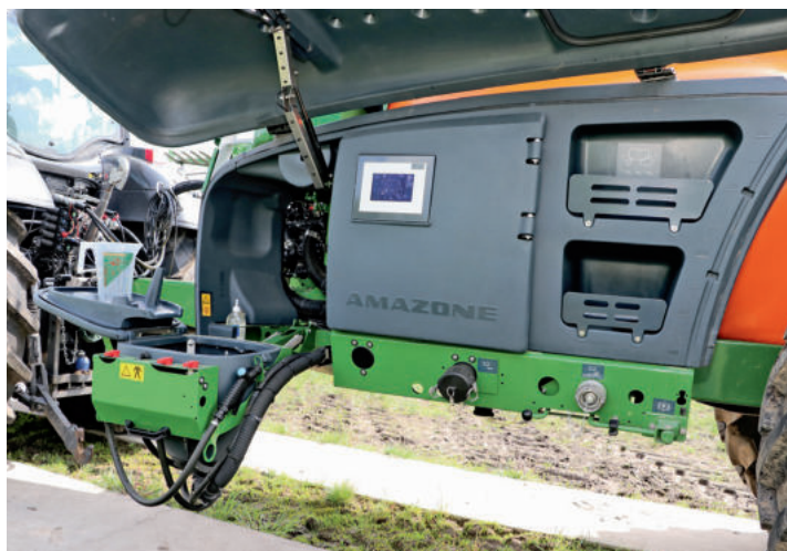
Mit dem Comfort-Paket plus werden alle Hähne der Spritze elektrisch verstellt und über einen Touchscreen bedient.
