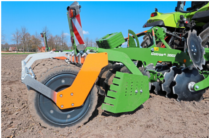
Die Keilringwalze mit dem Matrixreifenprofil rückverfestigt sehr ordentlich.
