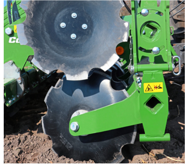
Die Randscheiben werden zum Transport hochgeklappt. Zusätzlich haben sie eine Feinjustierung für die Tiefeneinstellung.
