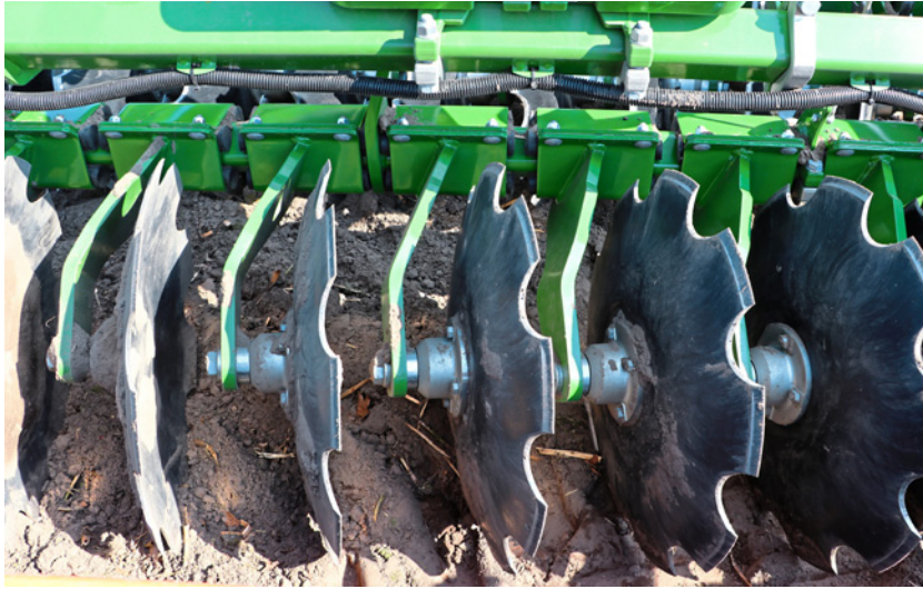
Jede Scheibe wird einzeln über Klemmscheiben mit dem Rahmen verschraubt. Die Schalen dienen gleichzeitig als Steinsicherung.
