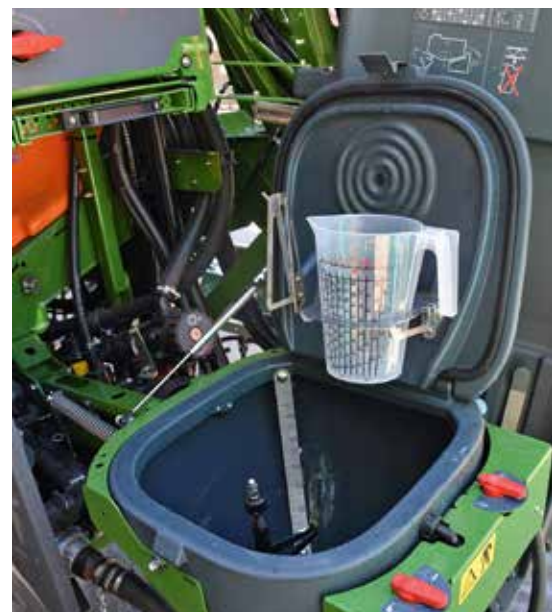
Rozwadniacz o pojemności 60 l ma m.in. uchwyt do naczynia pomiarowego.
