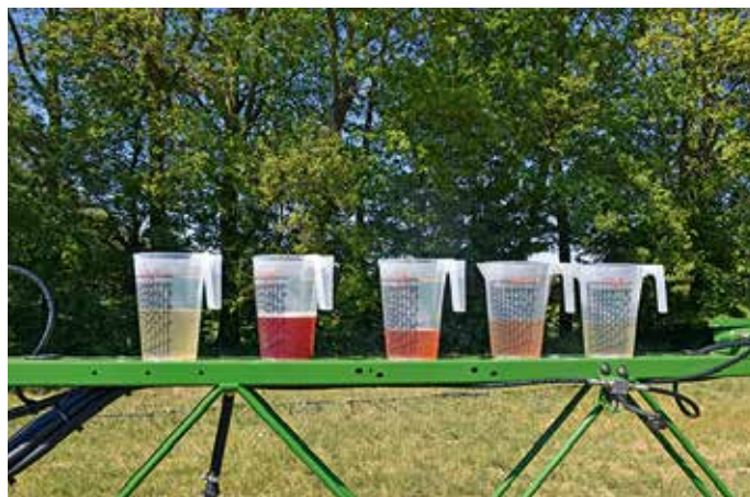
Sprawność układu mycia zbiornika sprawdziliśmy, wlewając do zbiornika sok z czerwonych buraków (od lewej przed myciem, z prawej po myciu – 1 min.).
