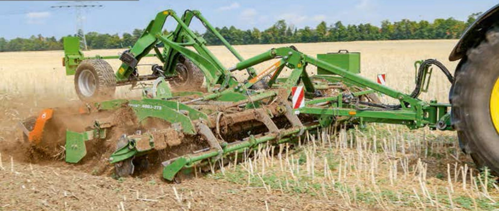
Catros XL sprawdza się podczas uprawy na niewielkiej i średniej głębokości. Dostępny jest także wał nożowy, zamontowany przed sekcją uprawową.
