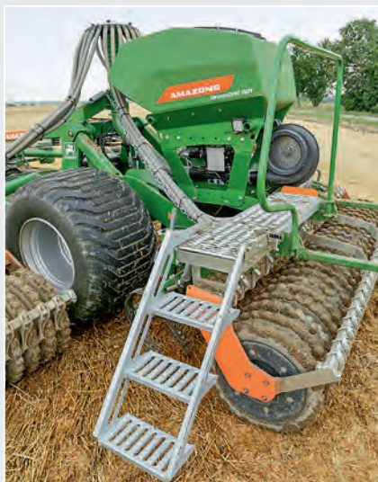
Siewnik GreenDrill ma pojemność 500 l, napełnianie go nasionami nie sprawia trudności.
