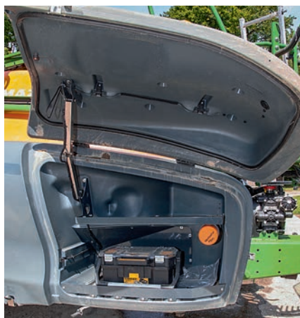
Schówek zabezpieczony przed kurzem ma poj. 240 l, może być oświetlony – bardzo dobrze.
