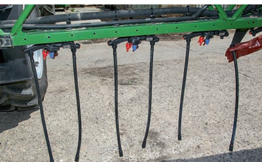
Uchwyty rozpylaczy z „przedłużeniem” pozwalają na montaż rozpylaczy co 25 cm i węży rozlewowych do nawozów płynnych.
