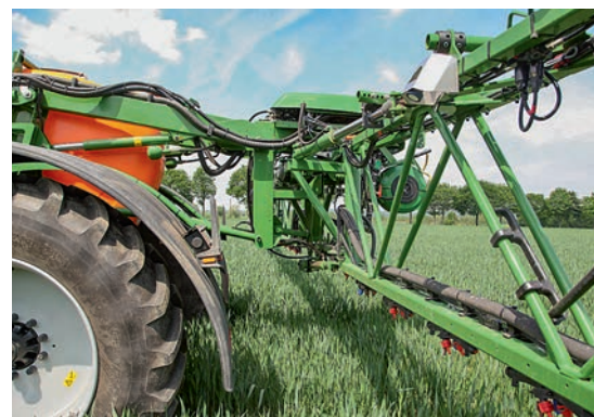
Nowe prowadzenie belki ContourControl pracuje z centralnym siłownikiem hydr., który aktywnie przeciwdziała wychyleniom belki.
