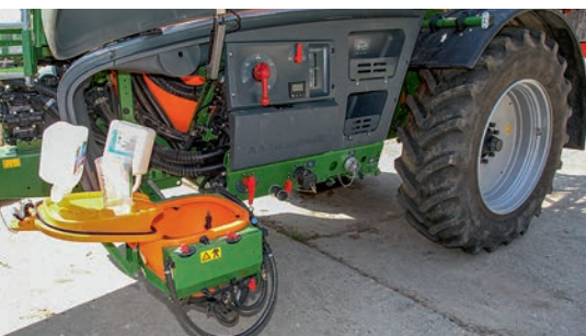
Rozwadniacz wydajnie zasysa ciecz, dzięki dwóm pompom wydajność napełniania jest imponująca i wynosi 705 l/min.
