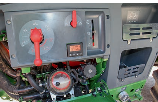
ComfortPaket zawiera: elektryczny zawór po stronie ssania i wyświetlacz, wielodrogowy zawór po stronie ciśn. obsługuje się ręcznie.
