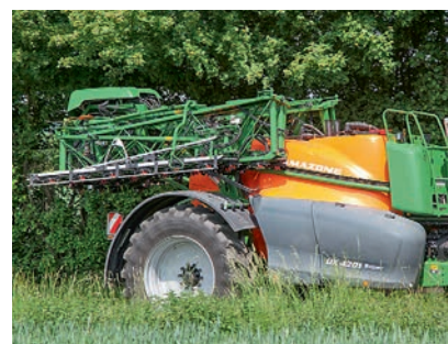
Belka Super L składa się szybko, po złożeniu ma kompaktowe wymiary. Układ hamulcowy z ALB i dopuszczalna masa całkowita 12,5 t pozwalają jechać 60 km/h z wypełnionym do pełna zbiornikiem, nawet z ciężkimi nawozami płynnymi.
