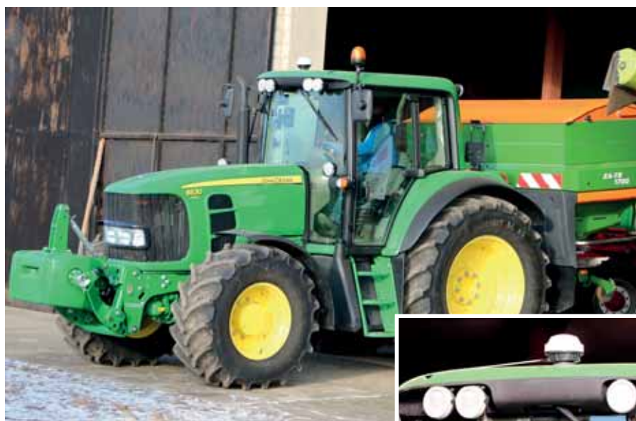
Rozsiewacz ZA-TS 1700 ProfisHydro z dwiema nadstawkami podnosi bezproblemowo John Deere 6630 premium o mocy 135 KM. Odbiornik nawigacji satelitarnej umieszczony na dachu ciągnika współpracuje z systemami: GPS-Switch, GPS-Maps i GPS-Track.
