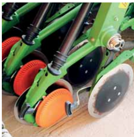
Siewnik AD 4000 Super wyposażony jest w redlice talerzowe RoTeC-Control, do których dzięki bocznym tarczom z tworzywa sztucznego nie przykleja się wilgotna gleba.
