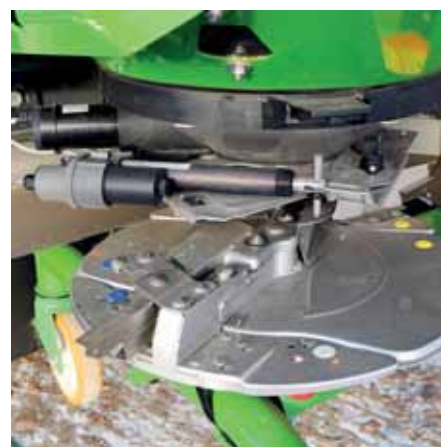
Napęd tarcz rozsiewacza ZA-TS jest hydrauliczny, ale za regulację wielkości szczeliny w dnie zbiornika i zamykanie wysypu nawozu odpowiadają silniczki elektryczne.
