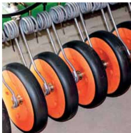
Zagarniacz rolkowy siewnika AD 4000 Super używany jest przy siewie rzepaku i zbóż. Po jego zastosowaniu pozostaje falisty profil powierzchni gleby, zapobiegający jej erozji.
