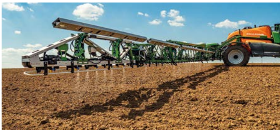
Opryskiwacz UX 5201 SmartSprayer wykorzystuje technologię kamer firmy Bosch.
