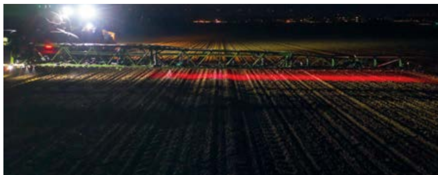
System SmartSprayer może również pracować w nocy. Maksymalna prędkość oprysku niezależnie od pory dnia wynosi 12 km/h.
